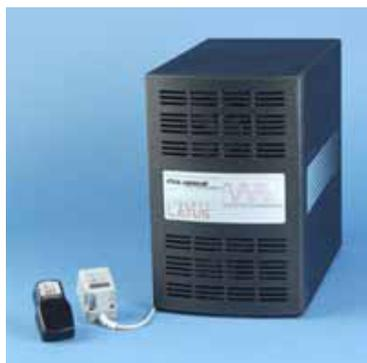
LIBERTY LATUSは、磁気を利用した3次元位置測定装置です。このシステムはレセプターと磁界発生源であるワイヤレスマーカ、それらを制御するコントロールユニット(SEU)で構成された6自由度測定装置です。磁気式センサーは、光学式や音波式とは違い、物理的な障害物に影響されずにデータをリアルタイムで提供致します。又、位置測定を担当する各マーカはバッテリー式のワイヤレスで駆動し、オペレーション時の配線の取り回しの心配が不要となり、より運動シミュレーション等の位置計測の機動性を実現しました。
