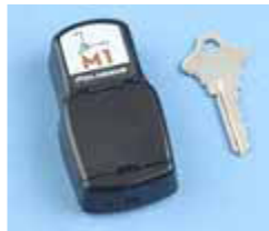
位置計測を行う ワイヤレスマーカ部(バッテリー内蔵)
