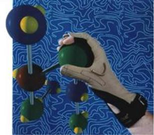
またサイバークロブにバイブレータを装備したサイバータッチは、指先に縫い込んだ6個のバイブレータが振動し、あたかも物体に触れたかのような感覚を得ることができるグローブです。
